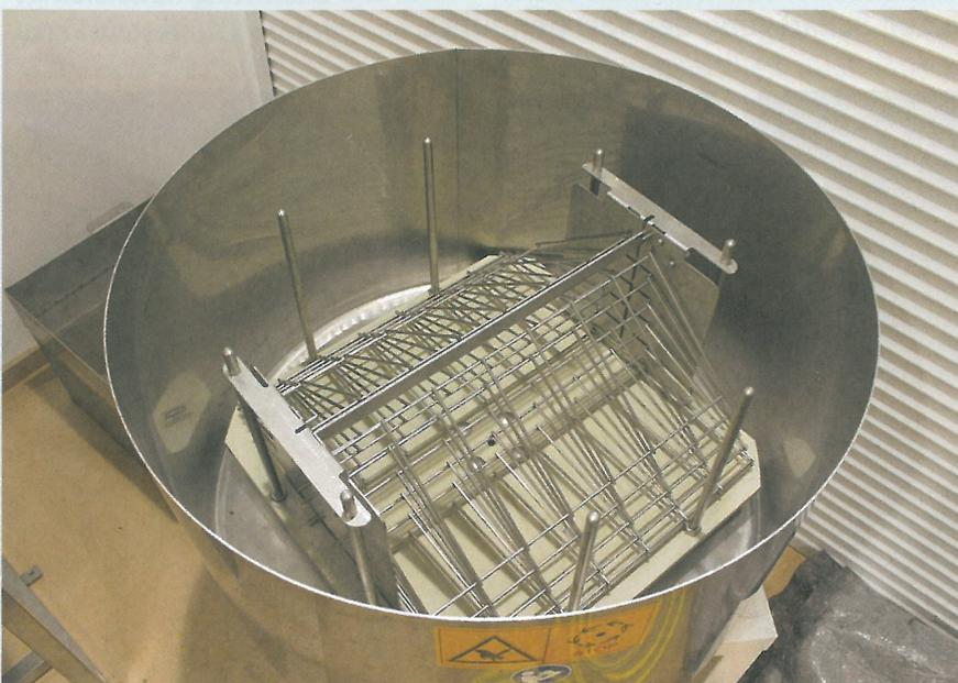
Der Honigkessel, als Schleuder mit dem gleichen Motor nutzbar.
